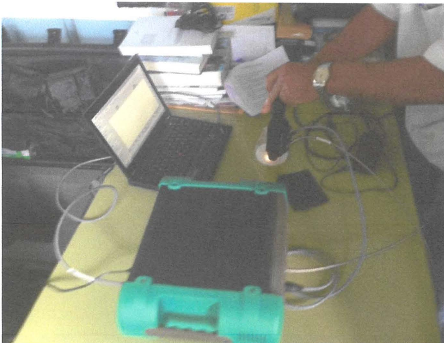
Figura 5: Foto do espectrômetro portátil FieldSpec 3™, utilizado no projeto.
